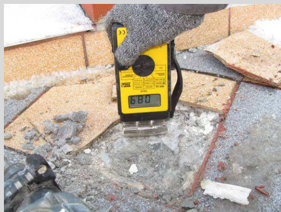
Fot. 03_4 Warstwa kleju zawilgocona (8,9%).
