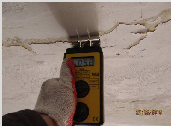
FOT_18. Pomiar wilgotności przegrody – przegroda mokra (~9,8%).
